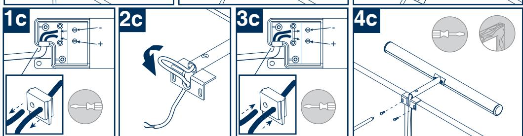
Sistema de enganche a camerino / Dressing room attachment system / Système d'accrochage armoire de toilette / Система крепления к навесному шкафу
